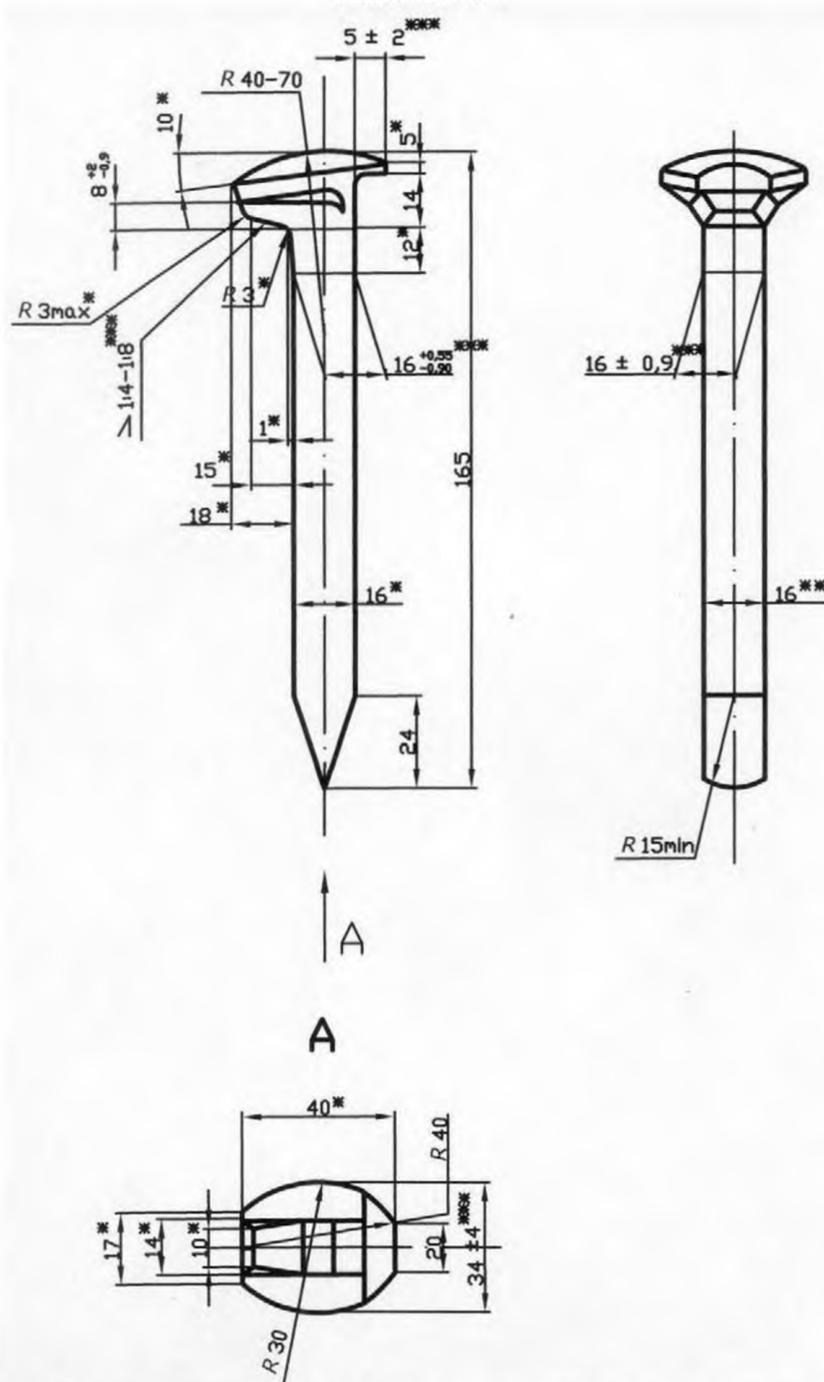
\* Размеры в готовых изделиях не контролируют, указаны для изготовления оснастки с предельными отклонениями  $\pm \frac{IT17}{2}$ .
