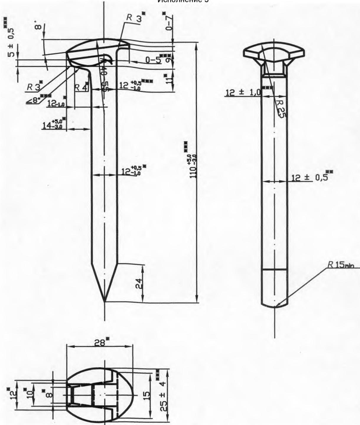
\* Размеры в готовых изделиях не контролируют, указаны для изготовления оснастки с предельными отклонениями  $\pm \frac{IT17}{2}$ .
