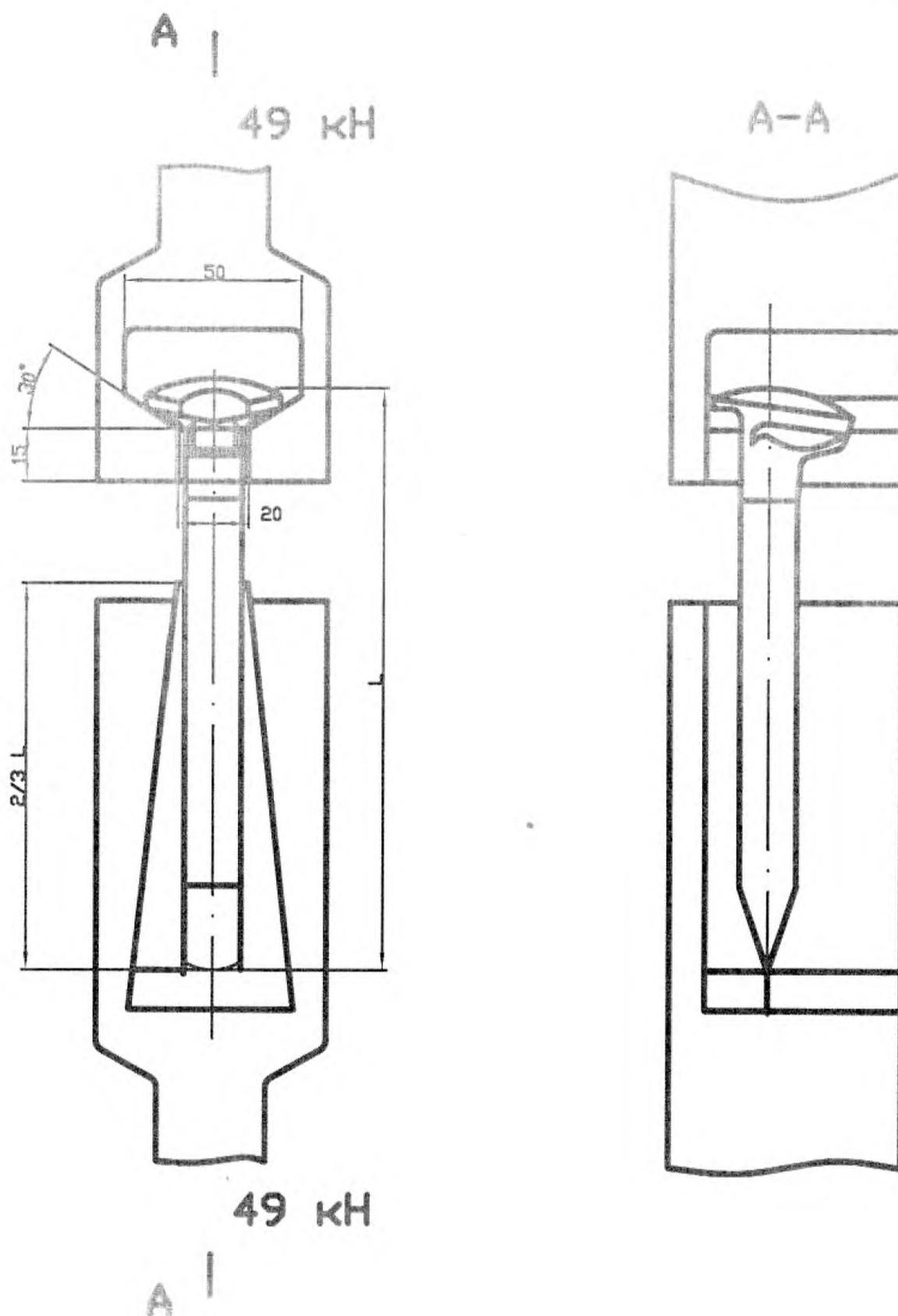
П р и м е ч а н и е – Вместо нижней части приспособления могут быть использованы зажимы разрывной машины.
